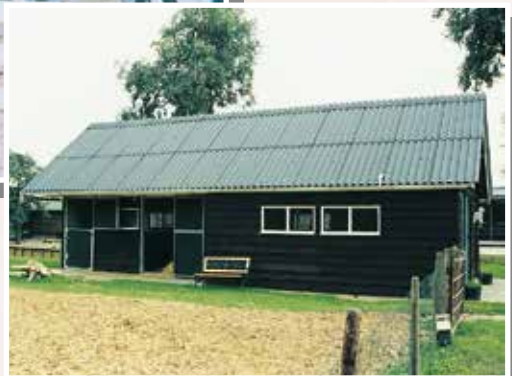
Garage/paardenstal, 1240 x 630 x 250 cm, dubbelwandig gepotdekseld, 45° zadeldak met zwarte golfplaten, 130 cm overstek. ▶
