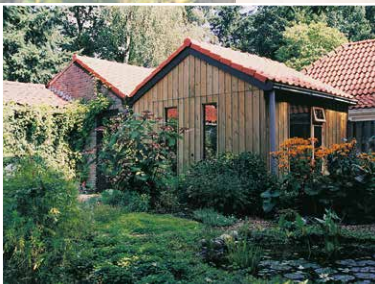
◀ Aanbouwatelier, 390 x 390 x 215 cm, dubbelwandig met verticale rabatdelen, 30° dak met pannen, geheel geïsoleerd.
