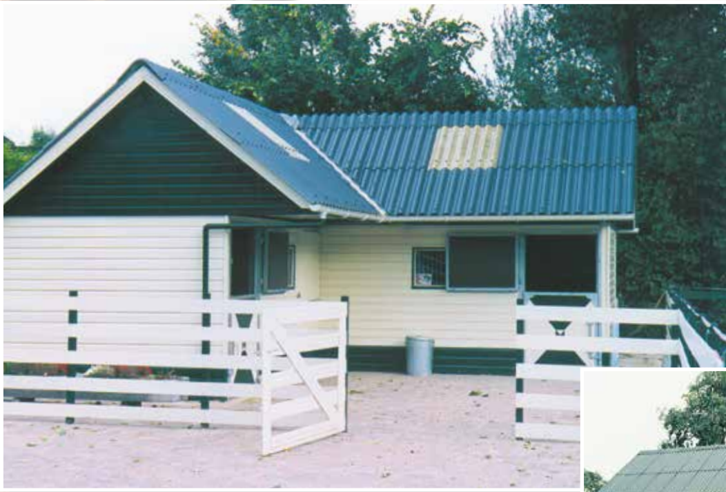
Garage/paardenstal, 1240 x 630 x 250 cm, dubbelwandig gepotdekseld, 45° zadeldak met zwarte golfplaten, 130 cm overstek. ▶
