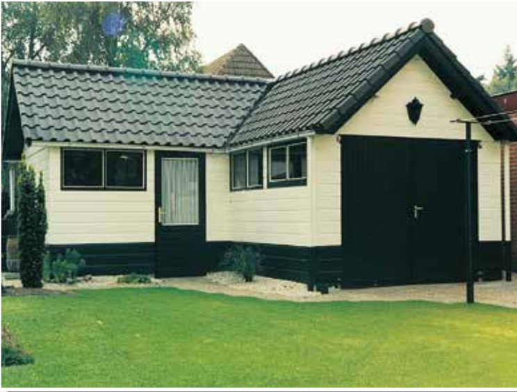
▲ Garage/berging 630/320 x 630/320 x 215 in L-vorm, dubbelwandig rabat, 45° dak met pannen, 1 stel draaideuren, loopdeur met venster en 3 ramen.
