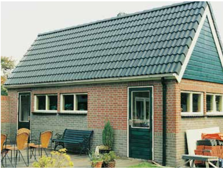
▲ Garage/berging, 780 x 320 x 215 cm, binnenwanden houtskelet, buitenwanden gemetseld, 50° dak met pannen, geheel geïsoleerd.
