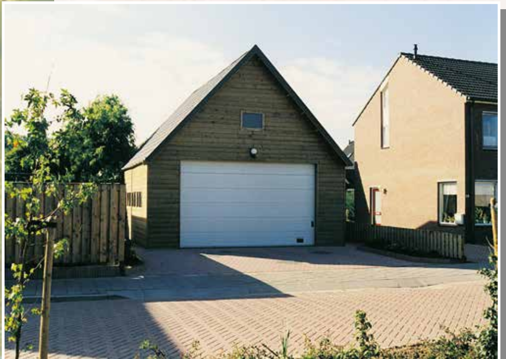
▲ Dubbele garage 780 x 630 x 285 cm, dubbelwandig rabat, 45° dak met panplaten, extra brede geïsoleerde sectionaaldeur.
