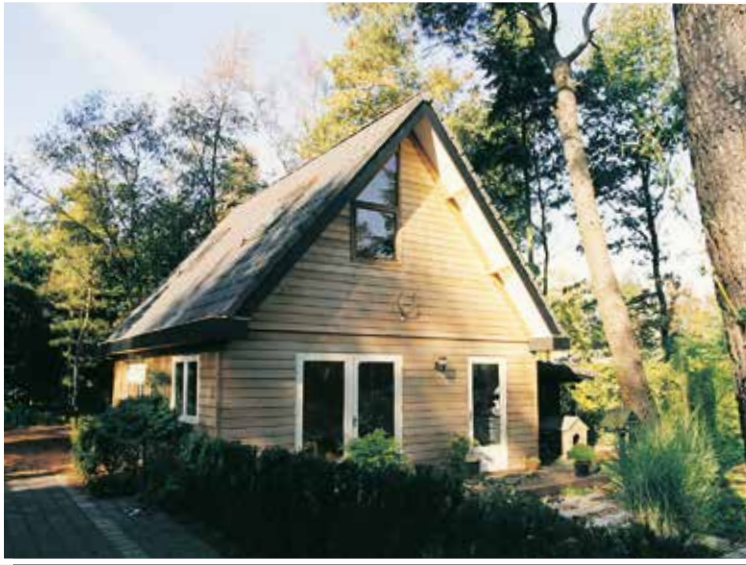
▲ Zeer fraai afgewerkt atelier, 930 x 630 x 250 cm, dubbelwandig rabat, 45° dak met pannen, 2 velux dakramen, bakgoten omtimmerd, geheel geïsoleerd.
