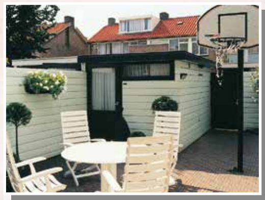
◀ Tuinhuis/hobbyruimte in L-vorm, dubbelwandig rabat, plat mastiek dak met rondom 30 cm overstek, schuifpui, merantie tuindeuren met roeden.
