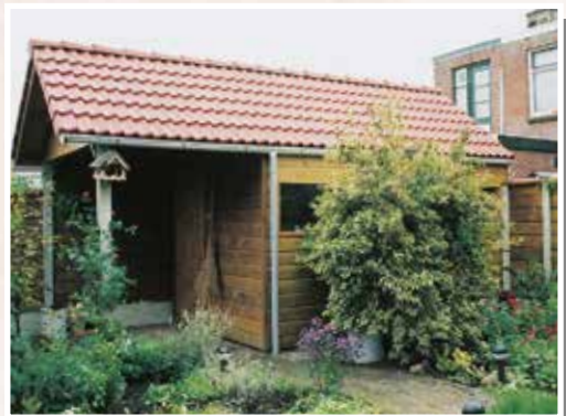
▲ Berging met overkapping, 475 x 320 x 215 cm, dubbelwandig rabat, 30° dak met pannen, in dezelfde sfeer aangebouwde enkelwandige rabat schutting.
