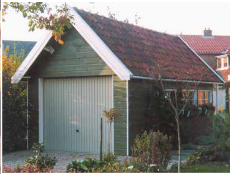
◀ Degelijke garage 630 x 320 x 215 cm, dubbelwandig rabat, 45° dak met oud-hollandse pannen en houten windveren, stalen kanteledeur.
